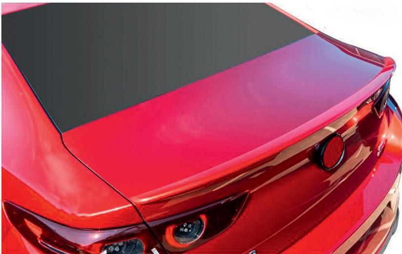
**Bild 3.** Für Automobilbauteile wie Heckspoiler wird ABS gerne genutzt, da es ein sehr ansprechendes Aussehen mit guten mechanischen Eigenschaften, etwa einer hohen Spannungsrissbeständigkeit, kombiniert. © Thaco
